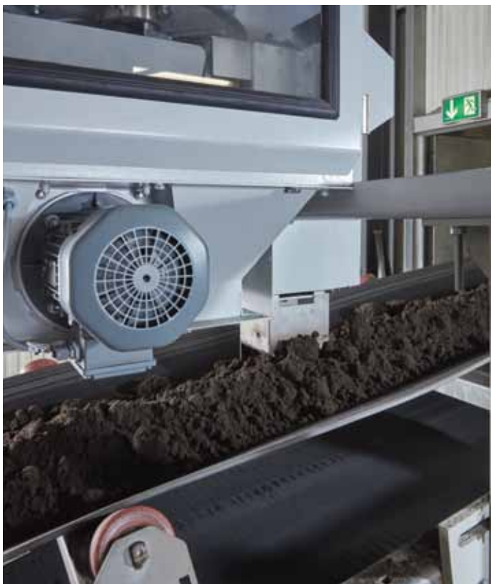
Тестер QualiMaster AT1 отбирает пробы непосредственно с транспортёрной ленты под смесителем. В базовую версию AT1 Есо может быть интегрирован опциональный измельчитель проб.
