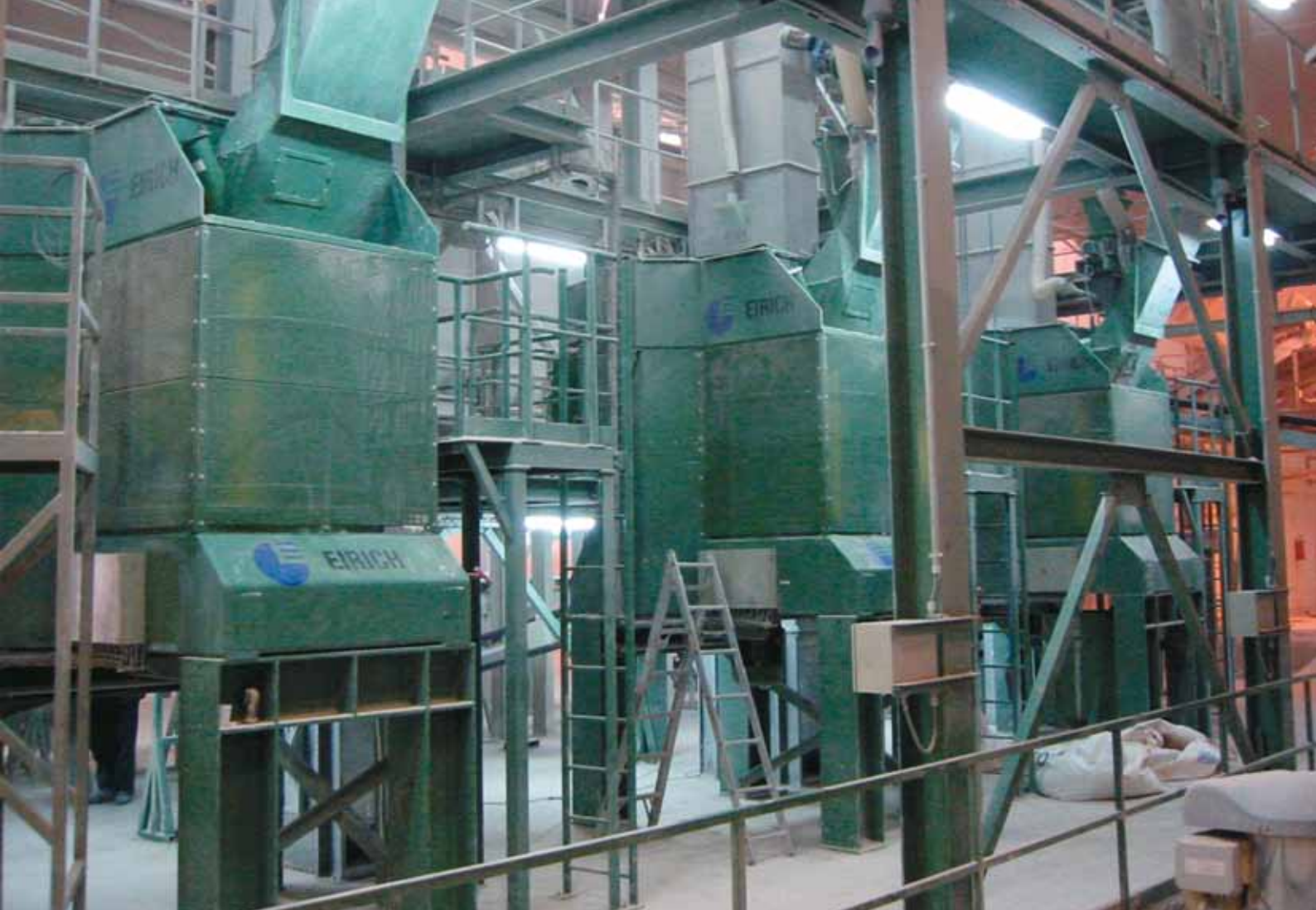
MM5 для сухого помола твёрдого материала для облицовочной плитки для стен и пола
