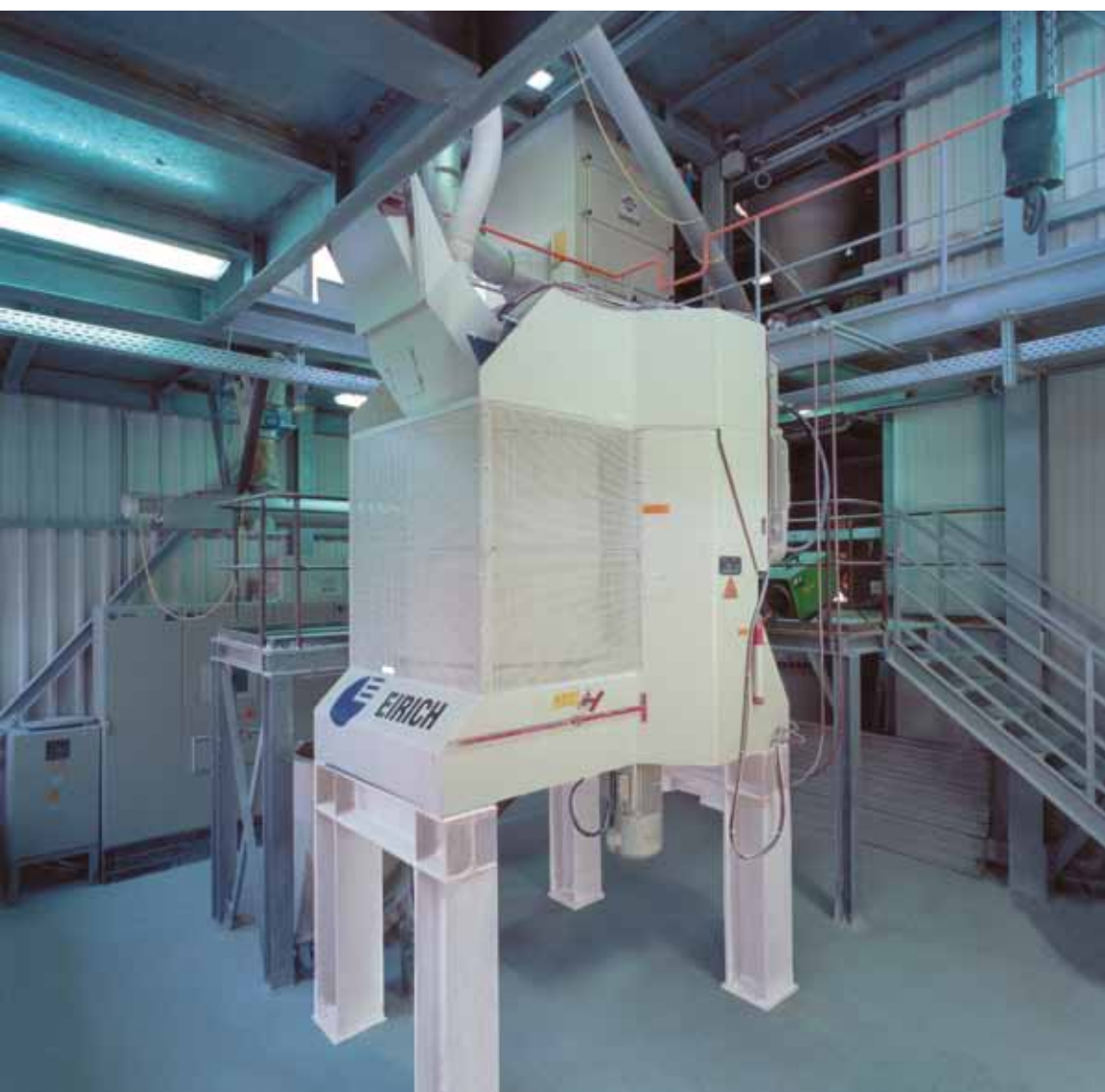
MM5 для сухого помола твёрдого материала для облицовочной плитки для стен и пола
