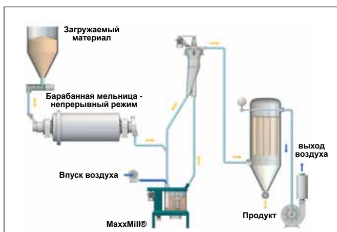
Барabanная мельница непрерывного режима (сухой помол) в сочетании с мельницей MaххMill®
